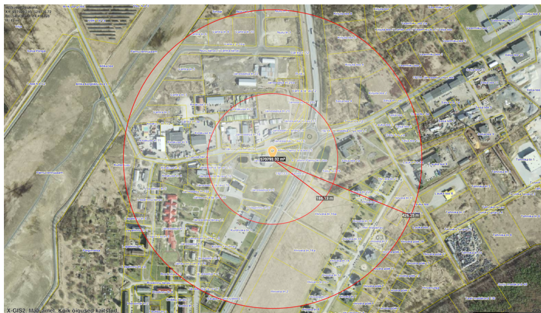
Joonis 3. Bensiini tsisternauto BLEVE ohualad.
