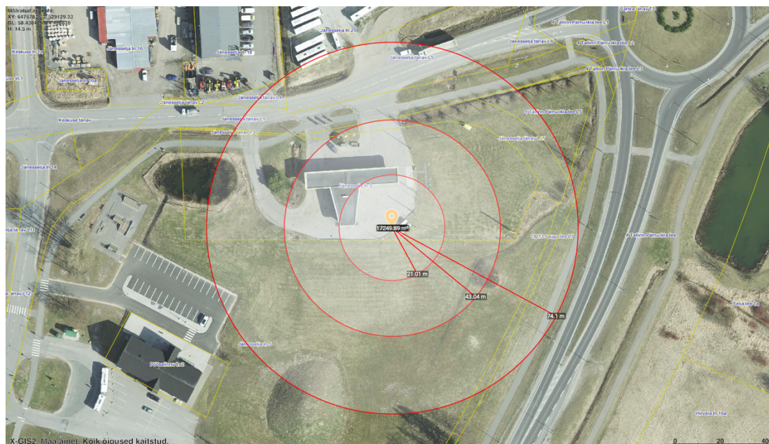
Joonis 2. Tsisternautost lekkiva LPG ohualad.
